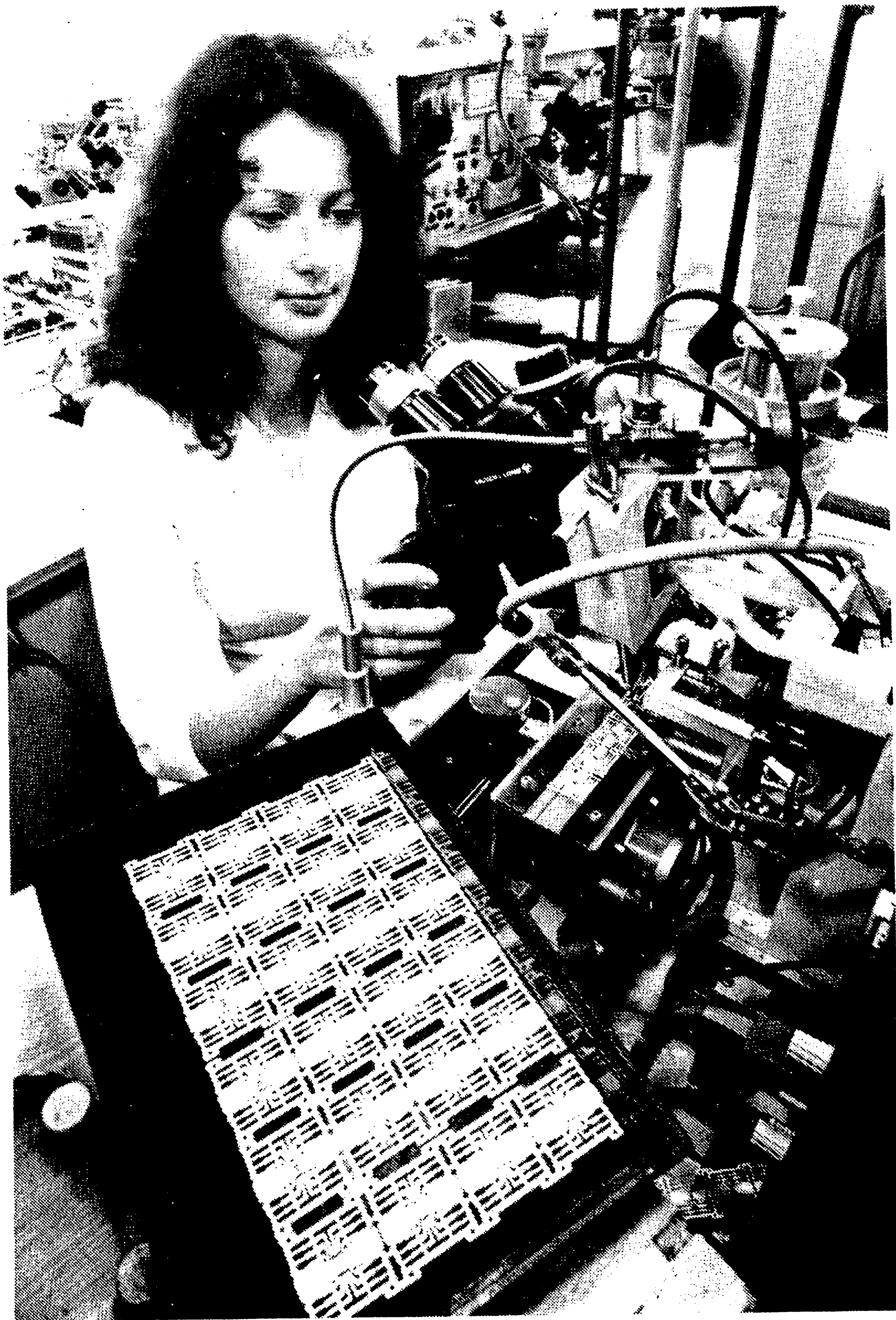
Obr. 4-17 Obsluha kontaktovacieho zariadenia na zapájanie integrovaného nízkofrekvenčného zosilňovača
